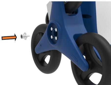
3、如图所示，将螺栓 M6x16 和平垫圈 6x18x1.6 装入螺丝孔内，并锁紧螺栓。
