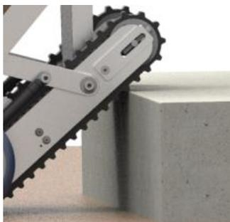
7、調整爬樓履帶，使後上方履帶的帶輪整體高於臺階平面，如圖所示。
