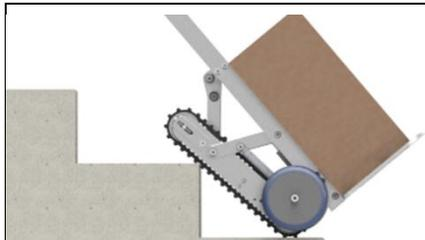
調整爬樓機至合適的上樓操作角度，保證後上方的帶輪整體都高於臺階面，如圖所示。（此時，機器必須處於爬樓狀態）
