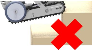
5、注意下樓時，同步帶後端離開上一級樓梯邊緣前，同步帶前端必須觸碰到下一級臺階平面或者樓梯邊緣。
